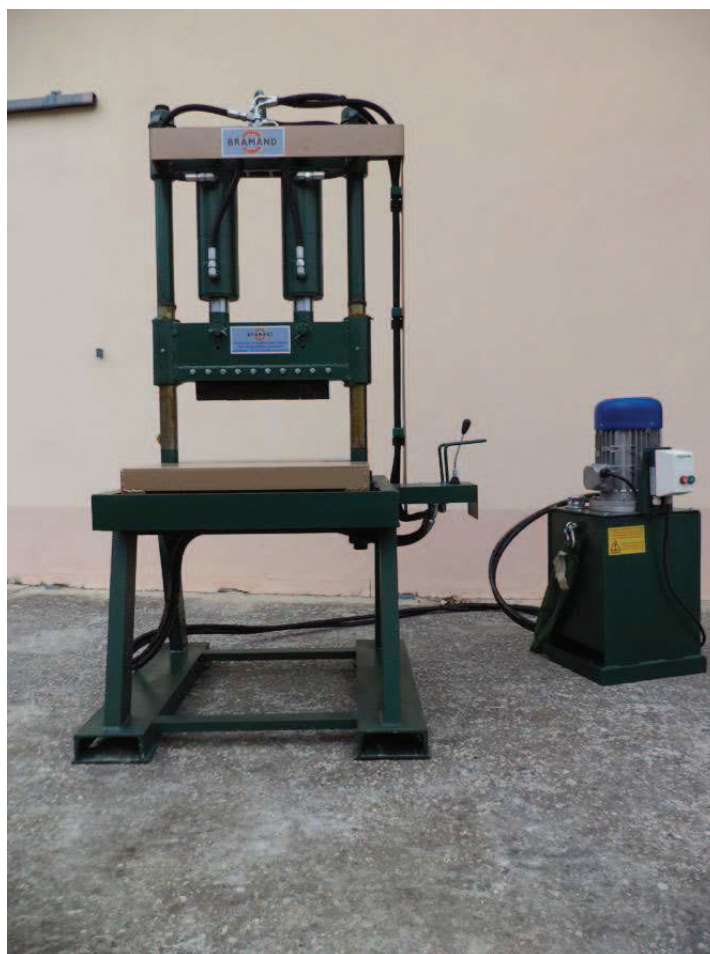
Eclateuse de pierres, avec moteur hydraulique (marque/type :Bramand EP50F) :
